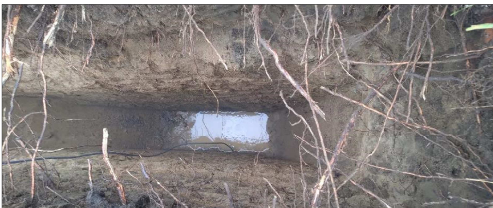
Obrázek 5: provádění vsakovací zkoušky
